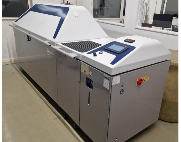
Figura 6 - Câmara de Nevoeiro Salino com Condicionamento Cíclico
