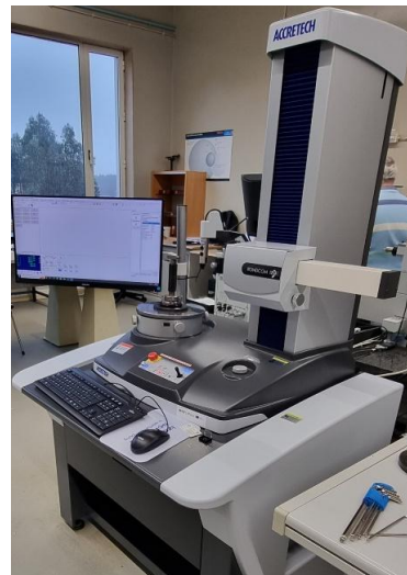
Figura 8 - Equipamento de Defeitos de Forma
