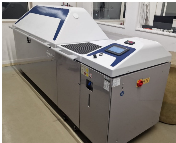
Figura 6 - Câmara de Nevoeiro Salino com Condicionamento Cíclico
